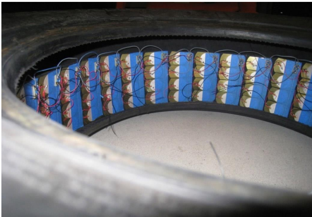
Figura 2 - Pneu com transdutores piezelétricos. Fonte: Prakash et al. (2014).
